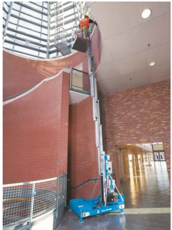
Mit dieser Option wird der Korb bei den Modellen IWP 25 S und 30 S durch eine elektrische Verriegelung gesichert. Unter Einsatz des seitlich ausschwenkbaren Korbes beträgt die Nutzlast 136 kg. Der IWP ist für Inneneinsätze konstruiert und kommt daher ohne zusätzliche Ausleger aus.
