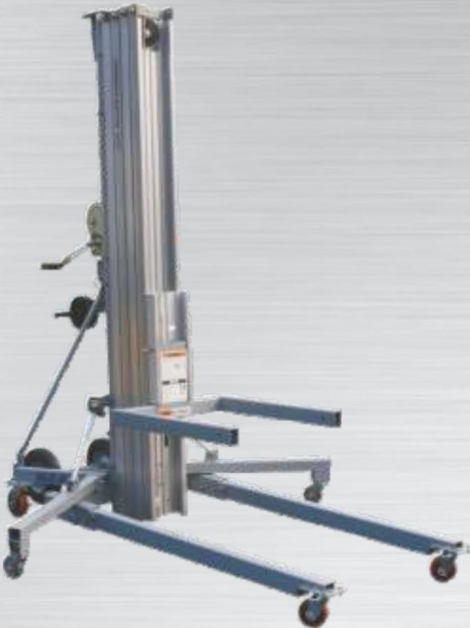
Der **Superlift Contractor** SLC 24 ist ideal für Hebearbeiten und Überkopfmontagen bis 7,32 m, wobei er 295 kg Nutzlast bietet. Er verfügt über zwei seitliche Ausleger, die bei Hubhöhen ab 5,00 m als zusätzliche Abstützung eingesetzt werden. Die großen Transportrollen machen den SLC besonders handlich auf der Baustelle. Er lässt sich damit für Montagen einfach ausrichten sowie von einer Person an verschiedene Einsatzorte bringen.
