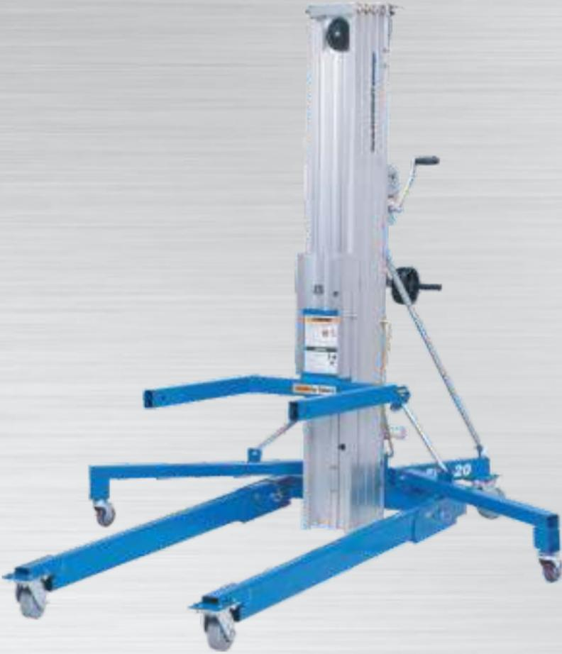
Der **Superlift Advantage** SLA 20 verfügt über eine Nutzlast von 363 kg, die auf bis zu 6,46 m Höhe gebracht werden kann. Auch beim SLA 20 gehören seitliche Ausleger mit Lenkrollen zur Grundausstattung. Der SLA sowie alle weiteren Genie und Wienold Materiallifte kommen bei Hubhöhen bis 5,00 m ohne seitliche Ausleger aus. Bei Hubhöhen über 5 m sind die seitlichen Ausleger einzusetzen, was den Platzbedarf in Arbeitsstellung je nach Modell verändert.
