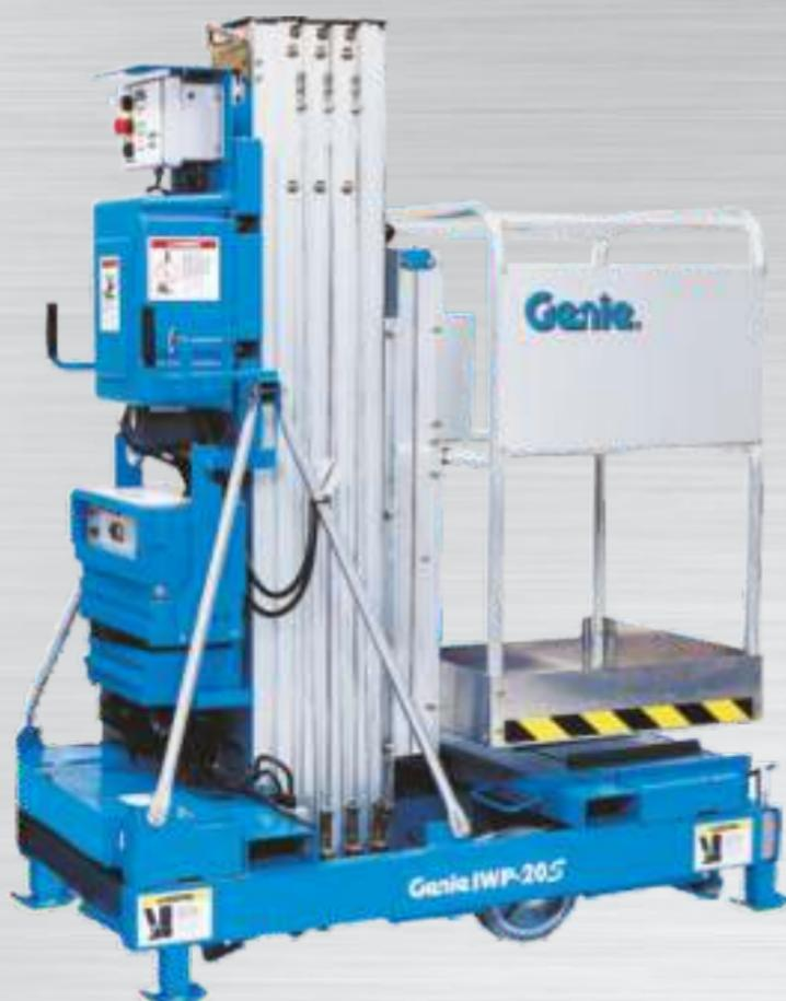
Die **Industrial Work Platform IWP 20S** kommt ohne zusätzliche Ausleger aus, was bis zu 40% Platz in Arbeitsstellung spart (im vgl. zum AWP). Sensoren im Sicherheitssystem justieren die Abstützung per Knopfdruck und gleichen Bodenunebenheiten bis 5 cm aus. Das Hochfahren des Korbs wird verhindert, wenn der Lift nicht sicher ausgerichtet ist. Der Korb ist seitlich um 61 cm ausfahrbar. Das bietet mehr Aktionsradius ohne den Lift neu positionieren zu müssen.
