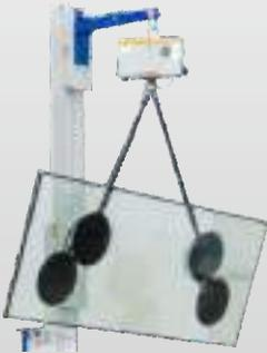
Der **Gurtsauger** verfügt über zwei Paar starre Saugteller, die an Gurten befestigt sind. Sie lassen sich variabel positionieren, z. B. an der Vorder- und Rückseite einer Tür. Er ist ideal für Fenster und Türen aus Kunststoff mit Sprossen, da er flexibel angebracht werden kann.
