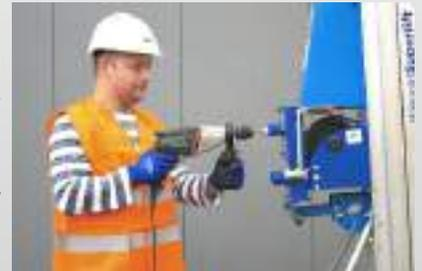
Antrieb mit Bohrmaschine
