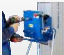
Das **3-Gang Untersetzungsgetriebe** erlaubt, Lasten per Handkurbel, Akkuschauber oder Bohrmaschine in 3 Unterstellungen zu heben und senken. Das Getriebe wird einfach auf die Schneckenwinde montiert. Lifte ohne Schneckenwinde müssen umgerüstet werden
