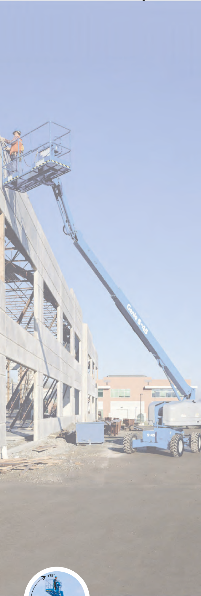
Jib: beweglicher Korbarm. Erweitert die seitliche Reichweite um 1,52 m und den Arbeitsbereich um 135°.
