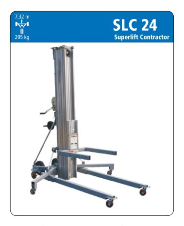
Der **Superlift Contractor** SLC 24 ist ideal für Hebearbeiten und Überkopfmontagen bis 7,32 m, wobei er 295 kg Nutzlast bietet. Er verfügt über zwei seitliche Ausleger, die bei Hubhöhen ab 5,00 m als zusätzliche Abstützung eingesetzt werden. Die großen Transportrollen machen den SLC besonders handlich auf der Baustelle. Er lässt sich damit für Montagen einfach ausrichten sowie von einer Person an verschiedene Einsatzorte bringen.
