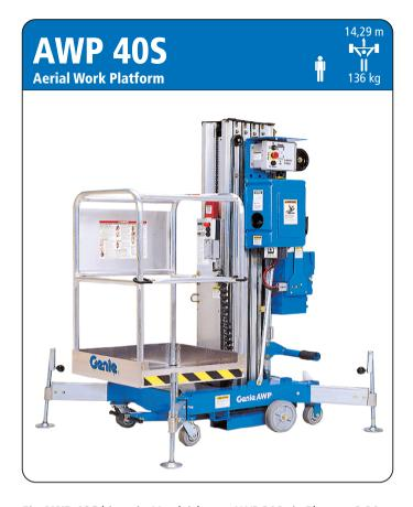
Ein **AWP 40S** bietet im Vergleich zum AWP 30S ein Plus von 3,30 m Arbeitshöhe: 14,29 m. Ein AWP ist leicht zu manövrieren, passt durch jede Standardtür und in fast jeden Aufzug. Für das Arbeiten über fest installierten Hindernissen, wie z. B. Bestuhlungen, Theken usw. ist ein **Super Straddle** erhältlich, mithilfe dessen sich die Hindernisse überbrücken lassen. Der Super Straddle baut 1,22 m hoch. sodass ein AWP 40 damit 15.51 m Arbeitshöhe erreicht.
