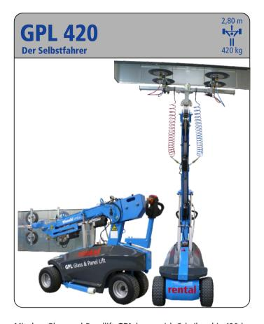
Mit dem Glass and Panellift **GPL** lassen sich Scheiben bis 420 kg transportieren und montieren. Der Selbstfahrer ist mit Luftbereifung ausgestattet, um beim Verfahren möglichst wenig Vibration auf die Scheiben zu übertragen. Die Steuerung befindet sich hinten an der Deichsel. Die Funktionen der Vakuumeinheit werden mit einer separaten Kabelfernbedienung gesteuert: Saugen, Lösen, Teleskopieren und seitlich Verschieben. Zwei seitlich ausklappbare Ausleger tragen zu erhöhter Standsicherheit bei.
