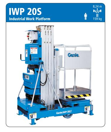
Die **Industrial Work Platform** IWP 20S kommt ohne zusätzliche Ausleger aus, was bis zu 40% Platz in Arbeitsstellung spart (im vgl. zum AWP). Sensoren im Sicherheitssystem justieren die Abstützung per Knopfdruck und gleichen Bodenunebenheiten bis 5 cm aus. Das Hochfahren des Korbs wird verhindert, wenn der Lift nicht sicher ausgerichtet ist. Der Korb ist seitlich um 61 cm ausfahrbar. Das bietet mehr Aktionsradius ohne den Lift neu positionieren zu müssen.
